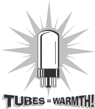
Uma válvula de vácuo tipo duplo tríodo 12AX7 é o centro do seu amplificador de série Bassman TV. Tipicamente, uma válvula 12AX7 dura por muitos anos, mas por uso constante e transporte com abalos freqüente, é possível que a válvula dure menos de 1 ano.
