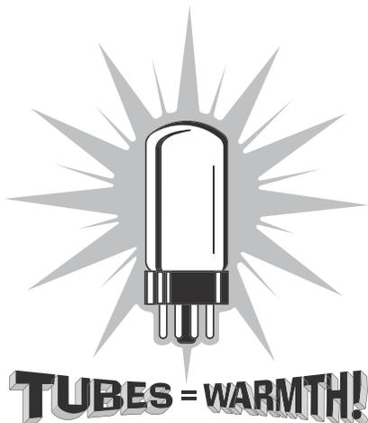
12AX7 双3極管チューブ(バルブ)は Bassman TV panel シリーズ・アンプの重要な部品です。通常 12AX7 チューブは数年間使用できますが、酷使したり頻繁な運搬による振動により、寿命が1年以下になる場合があります。
