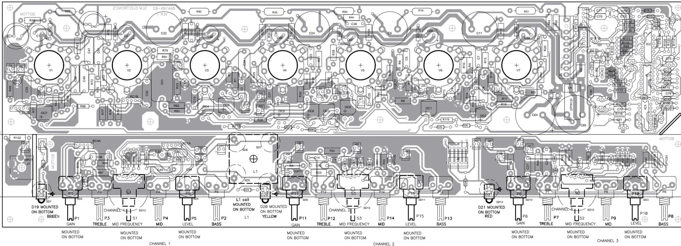
NOTE: INSTALL SOLDER MASK DISCS PRIOR TO WAVE SOLDER AS SHOWN OVER "BOTTOM SIDE" PADS OF COMPONENTS TO BE BOTTOM MOUNTED. (SD1-SD15)
